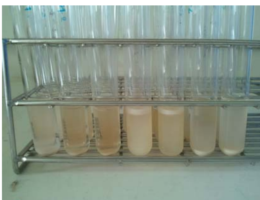
ภาพที่ 5.4 การตกตะกอนของชีวภัณฑ์แบคทีเรียปฏิชีวนะ B. velezensis ชนิดของเหลวแขวนตะกอนเข้มข้นสูตรต่างๆ
